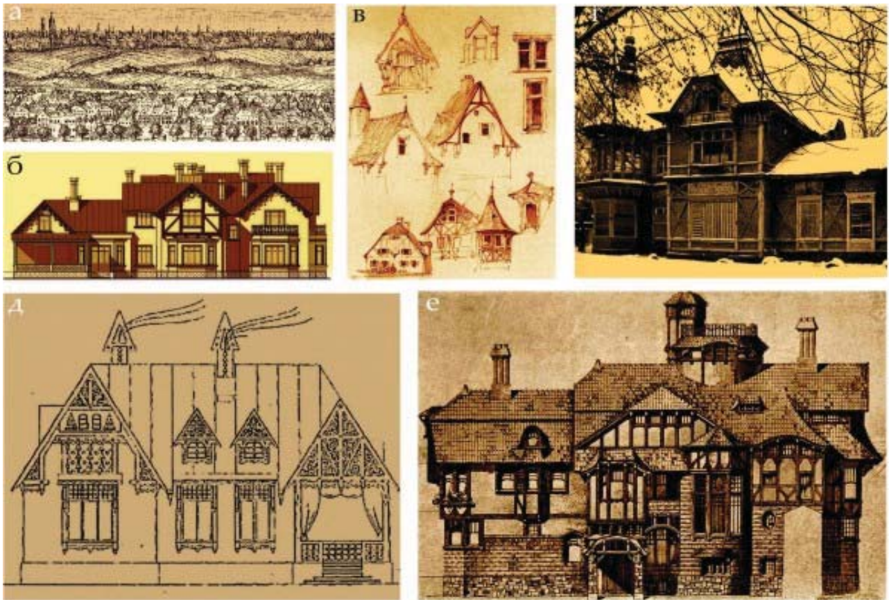
Рис. 2. Фахверковые строения Москвы и близлежащих пригородов в конце XVII – начале XX вв.: а – Новоиноземская слобода в 1670-е гг.(гравюра Г. де Витта); б – реконструкция усадебного дома в Крёкшине, вторая половина XIX в. ( http://wikipedia.org ); в – зарисовки элементов фахверковых строений В. Д. Поленова (из архива Д.В. Вадатурского); г - дом управляющего Болшевской бумагопрядильной фабрикой Товарищества Ф. Рабенека, Лапино-Спасское, 1890-е гг. – 2008 г. (фото автора); д – проект дачи, выполненный Г. Судейкиным, 1917 г.; е – усадебный дом в Льялове, 1906 – 1941 гг. (эскиз А.В. Кузнецова)
