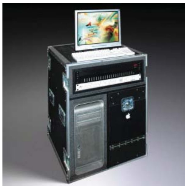
Рис.2. Медиа сервер Catalyst для управления и настройки аудио- и видеоконтента
