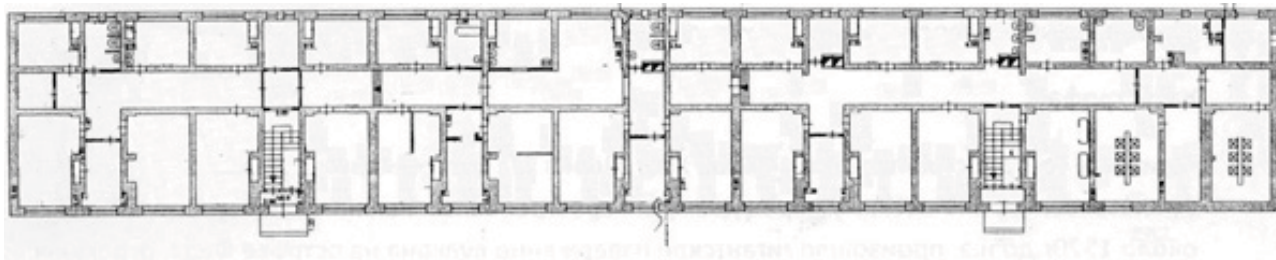
Рис.3. Магнитогорск. Дома с коллективными квартирами – «КО-А» для квартала № 1 (общежитие). План первого, второго и третьего этажей. 1931. (ул. Мояковского,40) Источник: Предоставлено Е.В.Коньшевой
