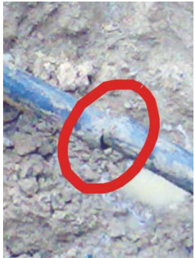
Рис.17. Авария на городском водопровode на ул. Амундсена, 100 в г. Екатеринбурге возле крыльца Института геофизики УрО РАН в ноябре 2009 г. Фото Осипова В.Ю., 2009 г. Чугунная труба диаметром 100 мм, проложенная в элювиальных суглинках по габбро, разорвана поперечной трещиной, по которой произошло смещение участков трубы.
