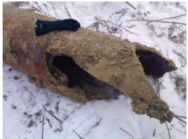
Рис. 16. Пример воздействия грунтов активного слоя земной коры на трубы городского водопровода, обусловленного сезонными изменениями объема и физико-механических свойств морозопучинистых грунтов. Авария на перекрестке ул. Амундсена и Краснолесья в январе 2010 года. (Фото Осиповой А.Ю.) Чугунная труба диаметром 300 мм сломана по причудливой траектории. Коренные породы, представленные габбро, вмещающими тело гранитоидов, залегают на глубине около 2,5-3,0 м. Возможно, что промороженные сверху грунты (на верхнем фото светлые образования в верхней части разреза), увеличив свой объем и ставшие более твердыми прижали трубу к консолидированным скальным породам, что способствовало ее разрушению.
