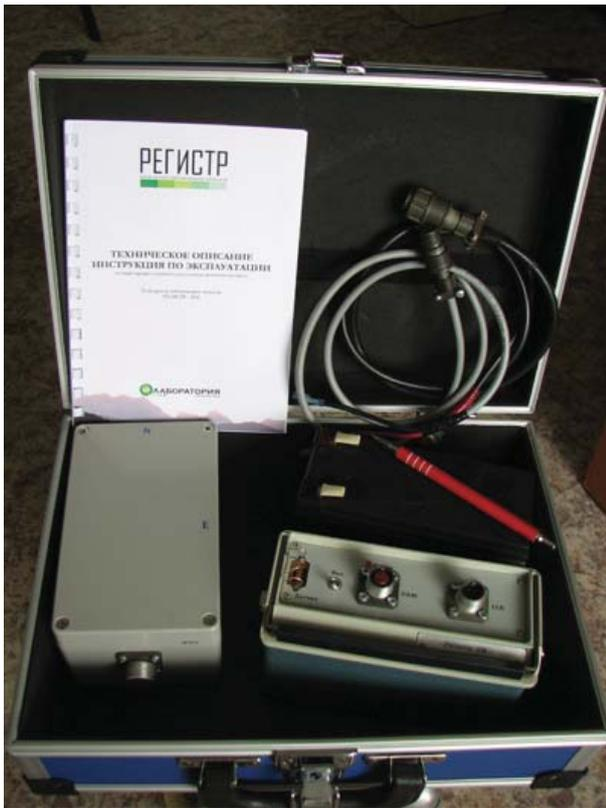
Рис.1. Внешний вид регистратора сейсмических сигналов «Регистр-3М» в комплекте.
