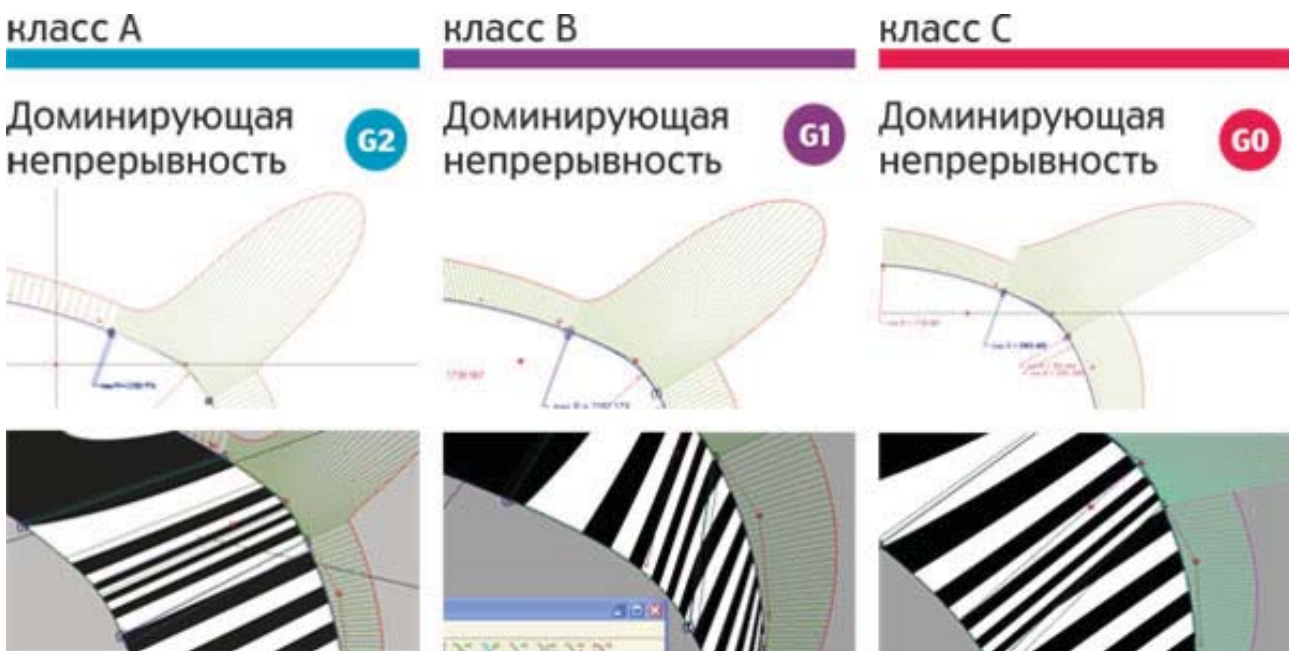
Рис. 2. Классы полисоставных поверхностей
