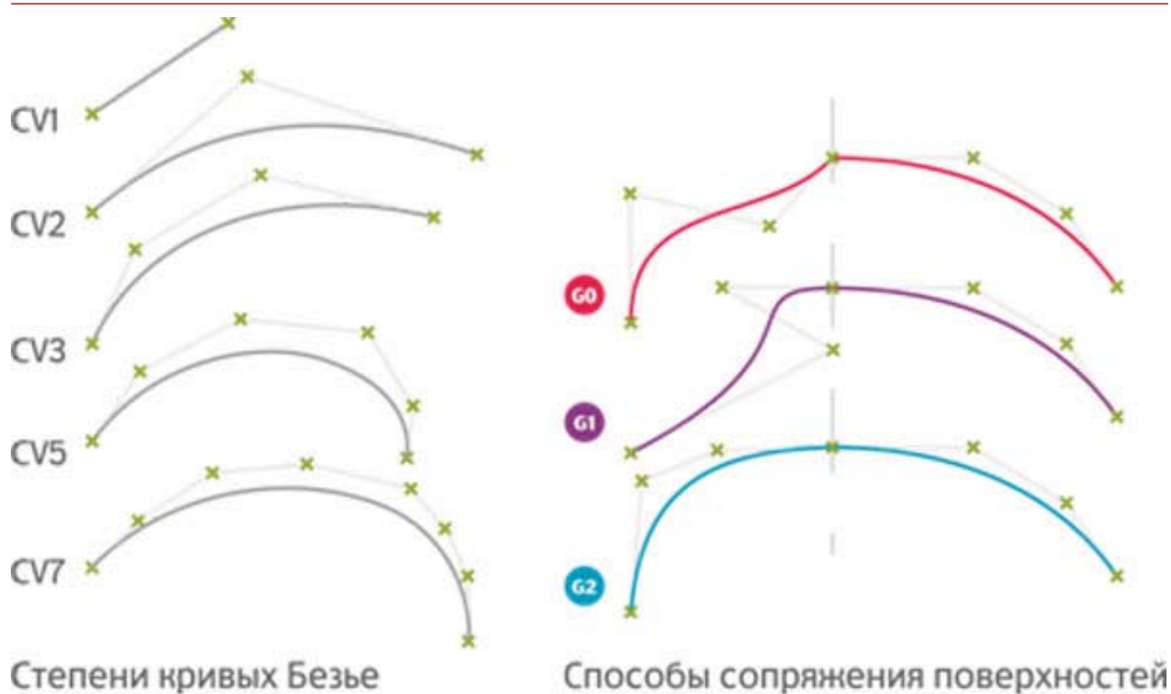
Рис. 3. Степени кривых Безье и способы сопряжения поверхностей на основе данных кривых
