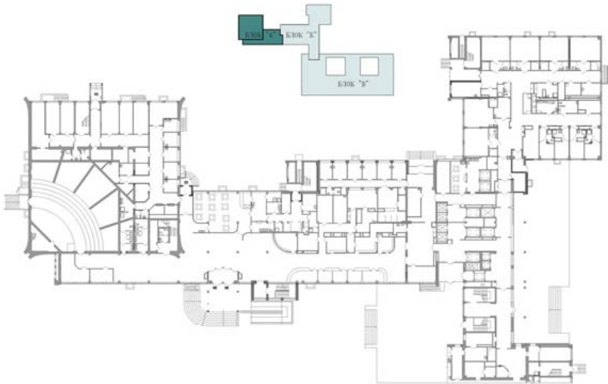
Рис. 7. БСМП-2, арх. ОАО «РОСТОВГРАЖДАНПРОЕКТ», 2007. План на отм. 0,000. Блок «А» - административный блок; блок «Б» - стационар
