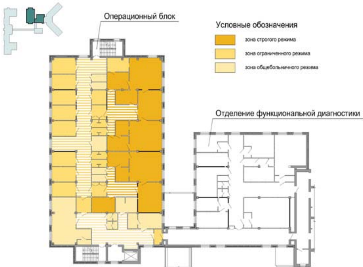
Рис. 8. Центральная районная больница г. Миллерово Ростовской области, арх. ОАО «РОСТОВГРАЖДАНПРОЕКТ», 2001. Корпус №2 Диагностический. План на отм. +6,600. Функциональное зонирование операционного блока
