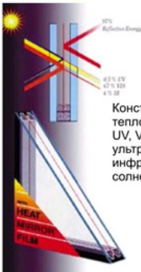
Конструкция и принцип работы теплового зеркала.
