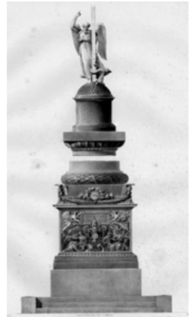
Рис. 11. Л.-Ж. Арну, с оригинала О. Монферрана. Детали Александровской колонны. Пьедестал, база, капитель и скульптура. 1836 г. Источник: http://coollib.com/b/285949/read
