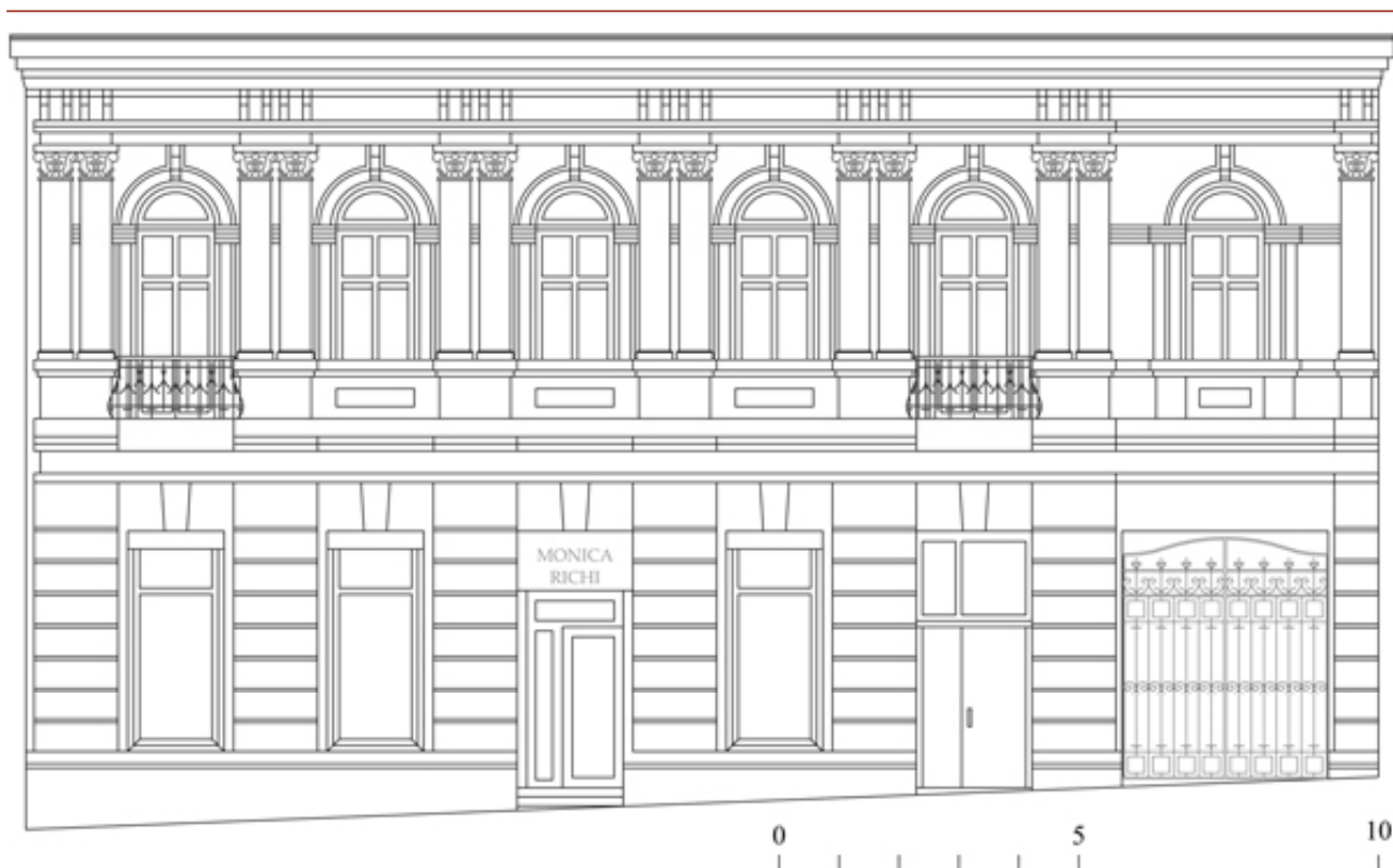
Рис. 4. Магазин Чистякова. Построен в 1903 г. Арх. И.С. Багинов. Фасад со стороны ул. Светланской. Чертеж автора
