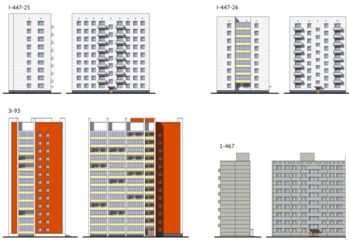
Рис. 21. Основные типовые серии многоэтажных кирпичных домов и домов с двухрядной разрезкой панелей
