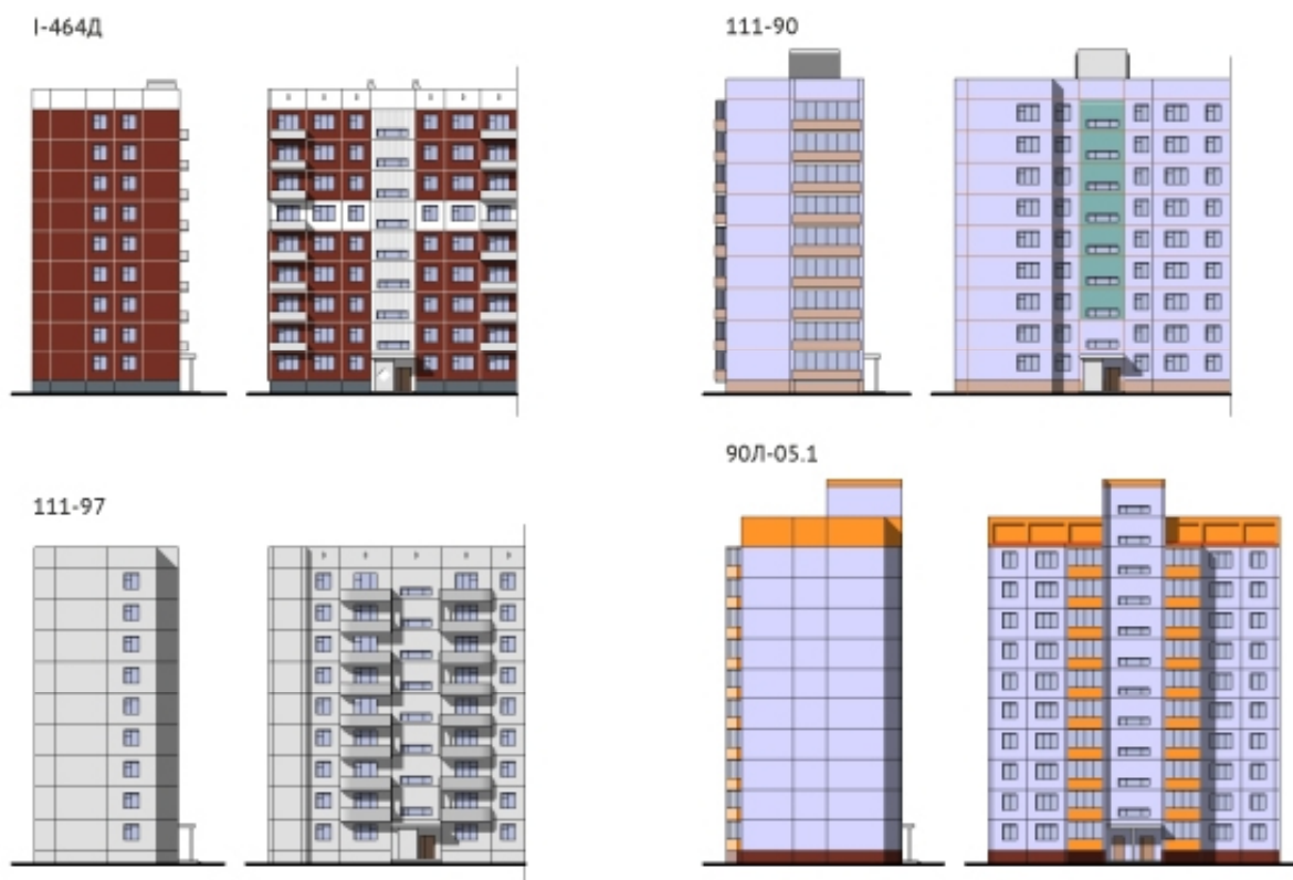
Рис. 20. Основные типовые серии многоэтажных крупнопанельных домов
