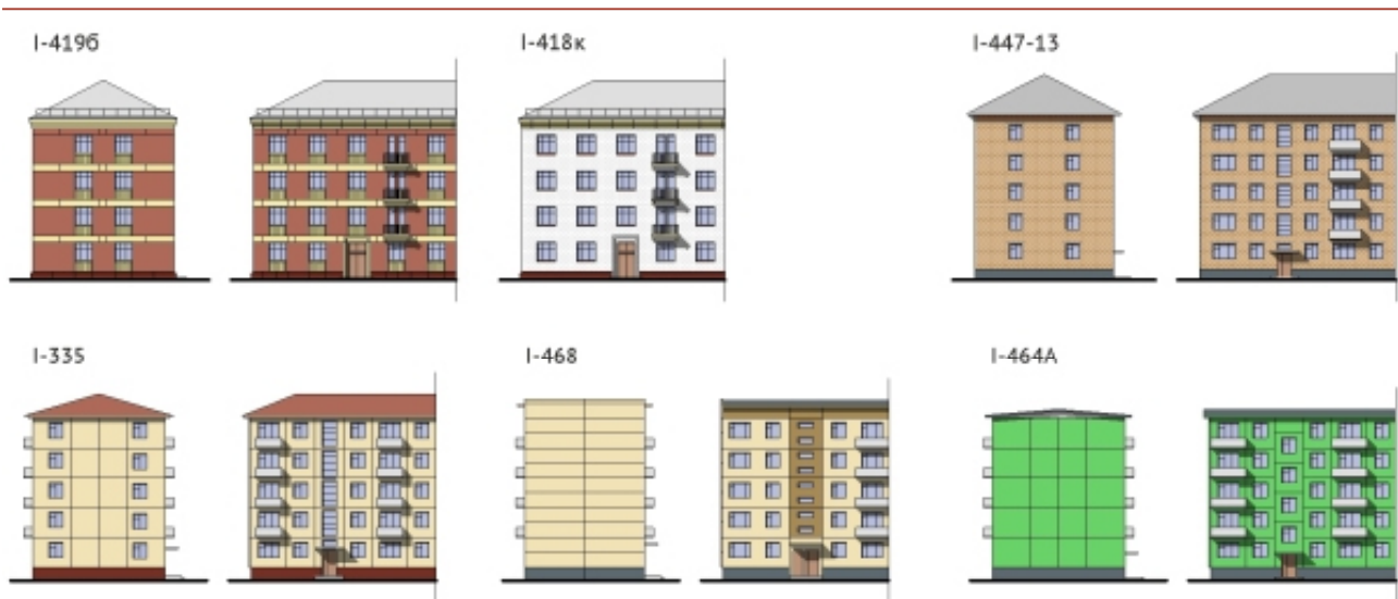
Рис. 19. Основные типовые серии домов средней этажности. Здесь и на следующих подобных иллюстрациях отступления от типовых проектов отражены по характерным новосибирским образцам соответствующих серий
