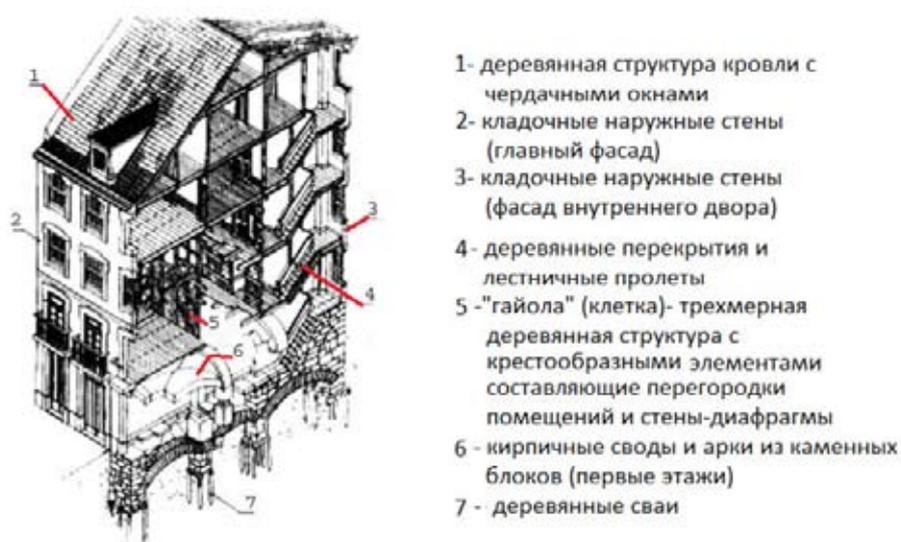
Рис. 14. Структурные детали здания «Помбалино». Рисунок адаптирован из Mascarenhas [11]
