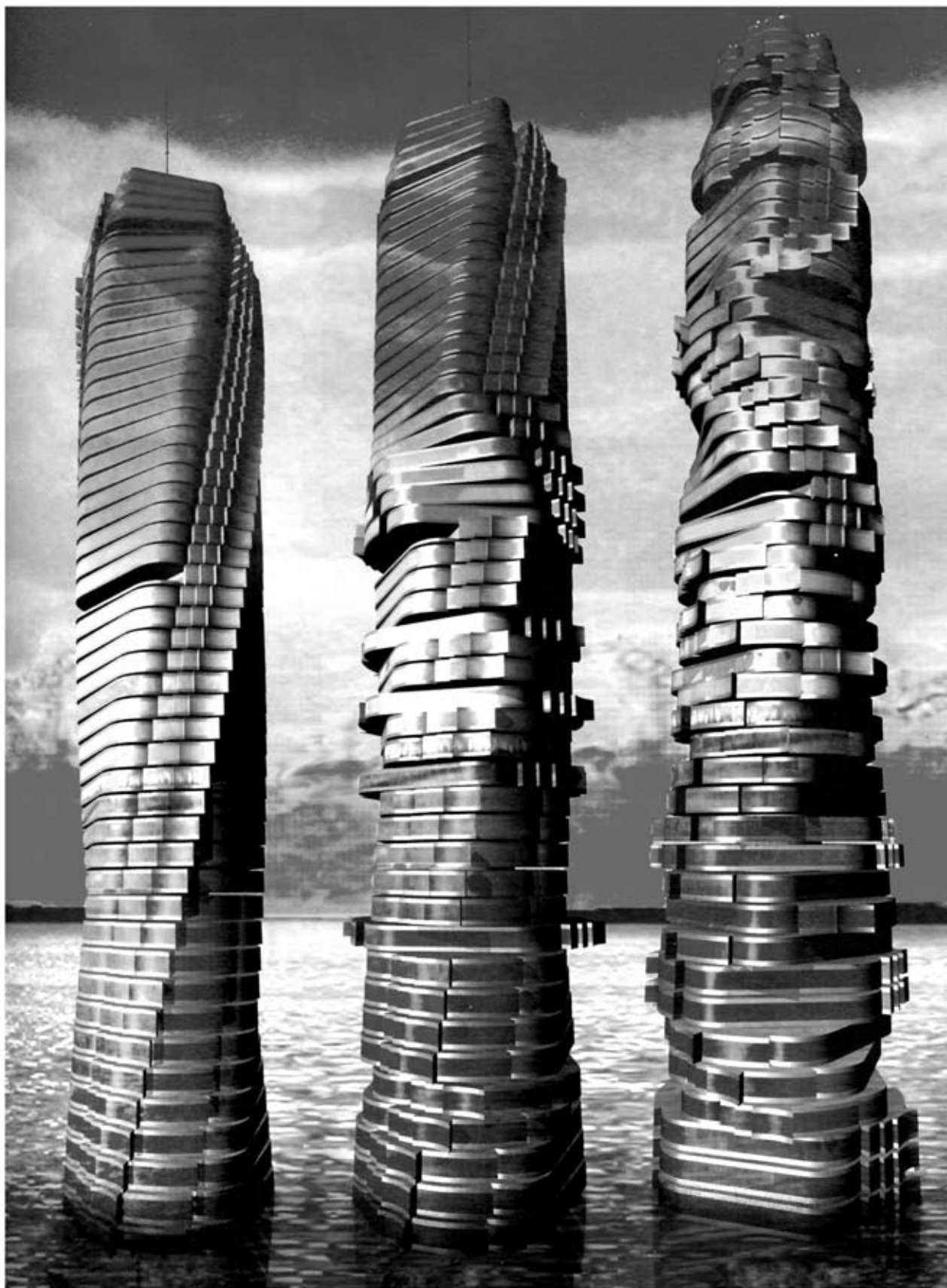
Рис. 11. Разновидности спиралевидных и иррегулярных рельефных/складчатых фактур со сложной пластикой поверхности, получаемых в процессе непрерывной трансформации горизонтально-слоистой структуры оболочки современного высотного здания [34].
