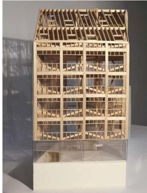
Рис. 5. Стоечно-балочная конструкция с щитовыми элементами жилого здания Wolokura (г. Монрёй, Франция) арх. Graam architecture Источник: <https://graamarchitecture.fr/WOLOKURA>
