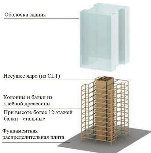
Рис. 7. Конструктивная схема FTTT. Выполнено автором на основе [10]
