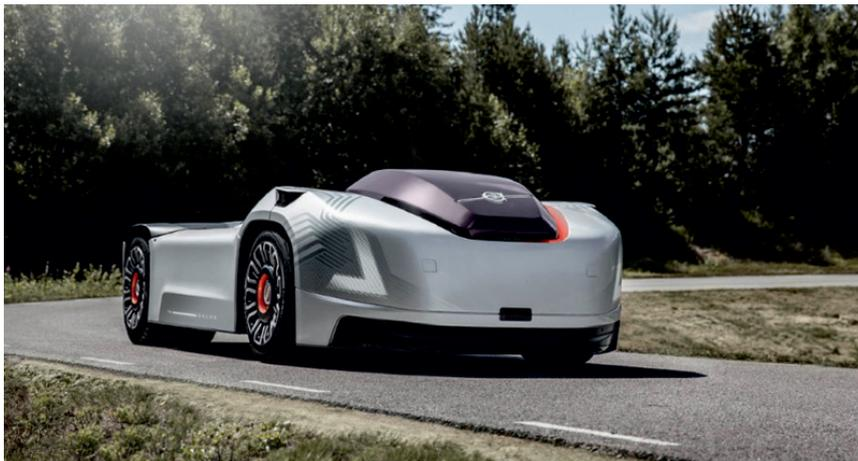
Рис. 7. Беспилотный моторный модуль грузового концепта VERA фирмы Volvo.
