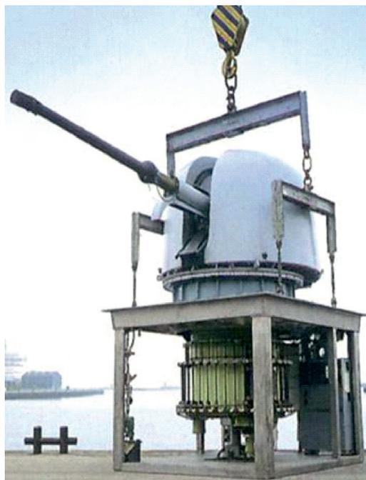
Рис. 5. Модуль с пушкой Oto Melara Rapid калибром 76 мм.
