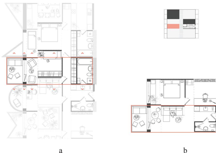
Рис.9. Принцип стыковки планировочных модулей: а – по горизонтали, б – по вертикали
