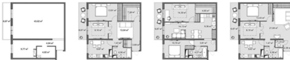
Рис. 2. Несколько вариантов планировки одной квартиры
