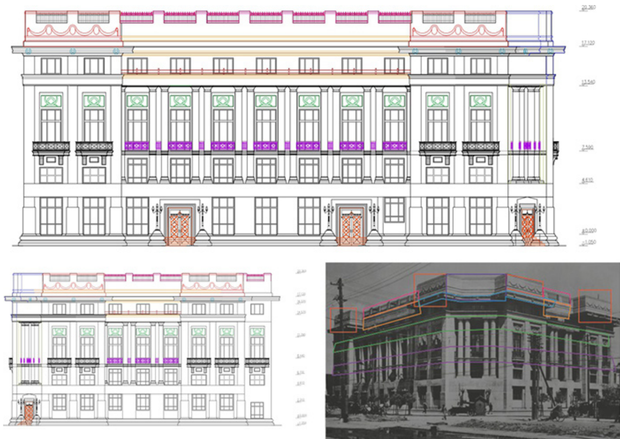
Рис. 7. Отделение Британского банка в Харбине. Графическое восстановление исторического облика [6, с. 66] с дополнениями Д.А. Лава
