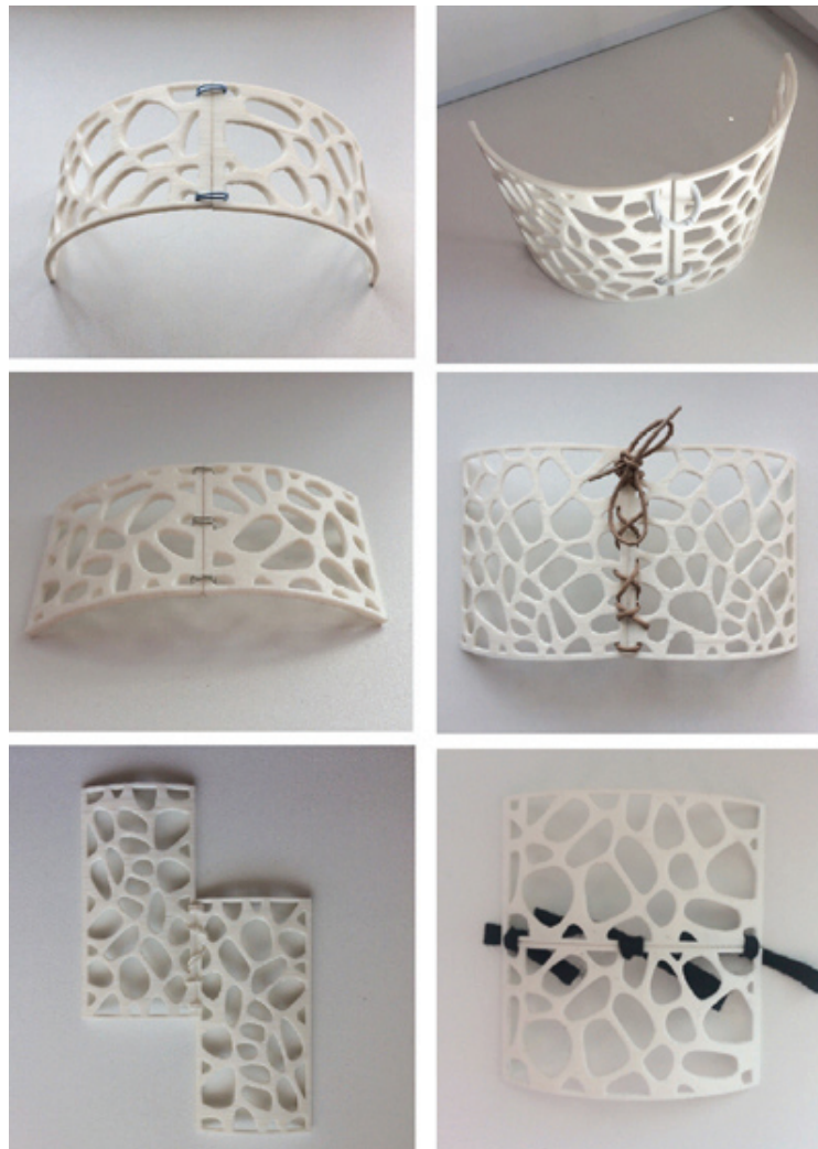
Рис. 8. Варианты крепления 3D-элементов между собой
