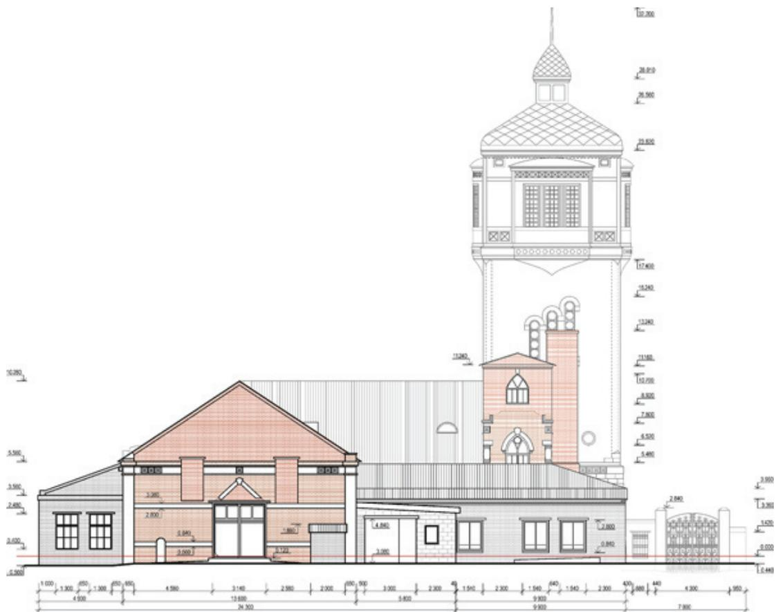
Рис. 6. Фасад здания со стороны р. Волги. Фиксация по состоянию на 2019 год. Обмерный чертеж С.А. Березкина
