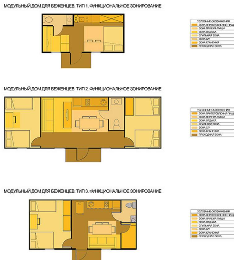
Рис. 8. Модульный дом для беженцев. Тип 1-3. Функциональное зонирование
