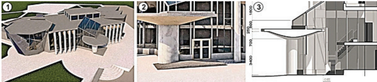
Рис. 3. Устройство универсального входа в курсовом проекте Досугового центра: 1) общий вид здания Досугового центра; 2) общий вид входной группы; 3) разрез по входной группе. Источник: Демонстрационный планшет курсового проекта студ. А. Волкова
