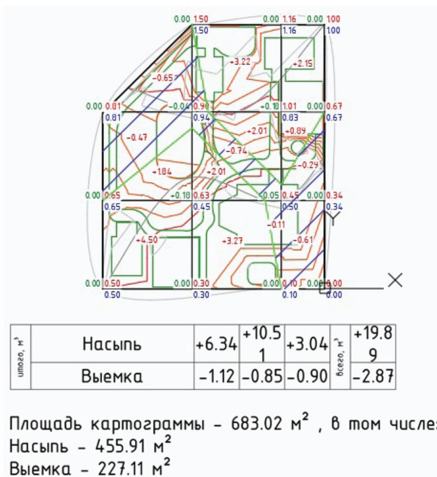
Рис. 13. Вычисление объемов с помощью **Метода квадратов** при использовании утилиты **Картограмма земляных масс (BearDyugin)**
