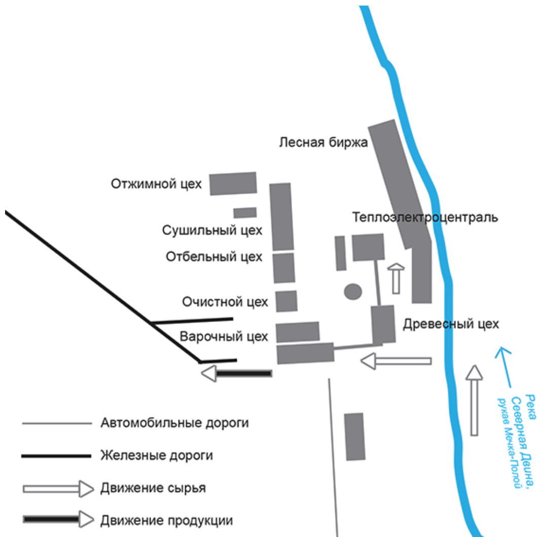
Рис. 3. Схема размещения основных цехов Архангельского целлюлозно-бумажного комбината к 1940 г. Составлено автором
