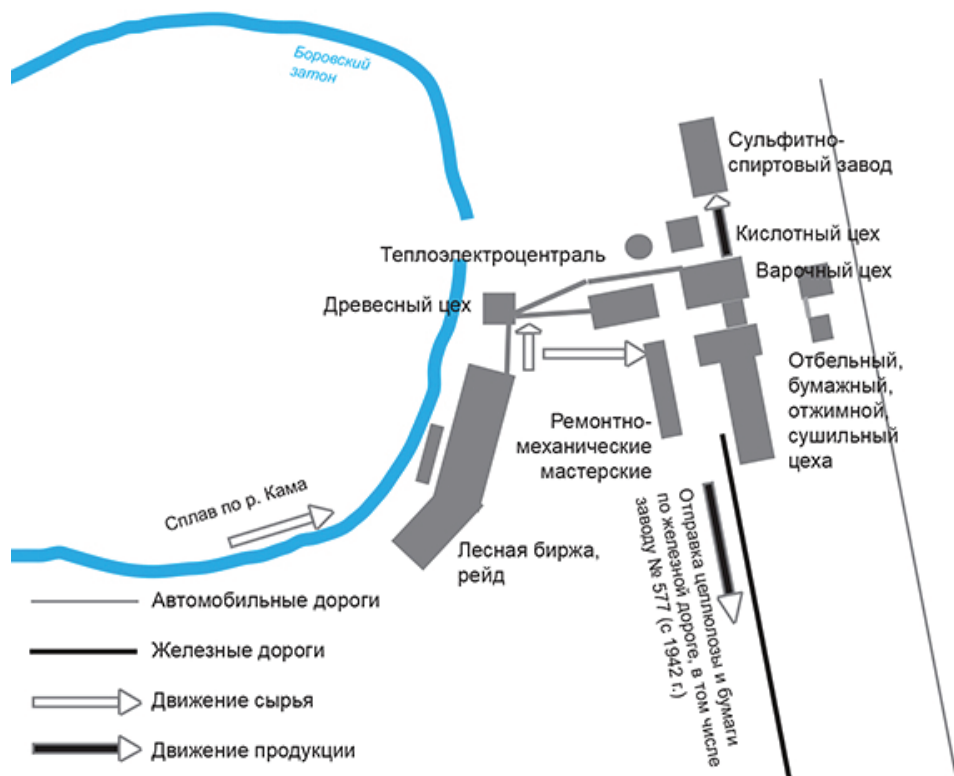
Рис. 9. Схема размещения основных цехов Соликамского целлюлозно-бумажного комбината к 1940 г. Составлено автором
