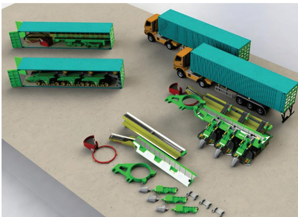
Рис. 2. Сборка и технологические членения агрегатов транспортного комплекса в соответствии с требованиями логистики. Дизайнер В. Быстров
