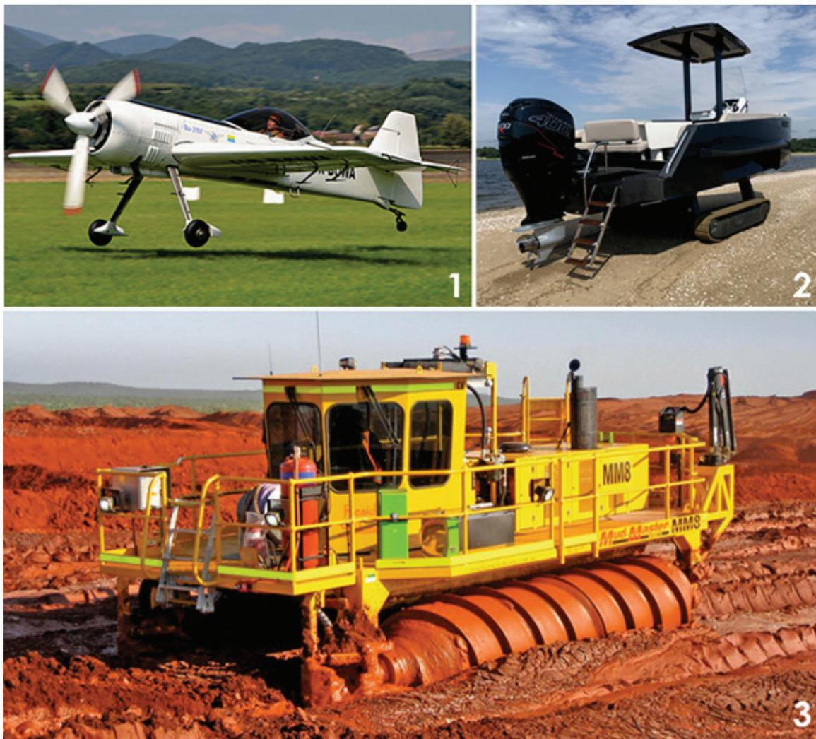
Рис. 3. Винтовые движители транспортных средств, функционирующих в разных природных средах:
