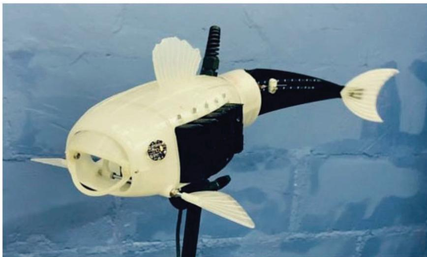
Рис. 2. Рыба-робот для очистки водоемов от пластика. Источник: <https://www.osnmedia.ru/>
