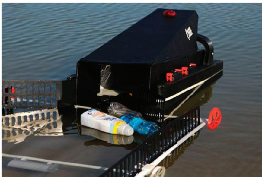
Рис. 3. Беспилотный плавательный аппарат Black TrashWhale. Источник: <https://tlt.ru/ecology>
