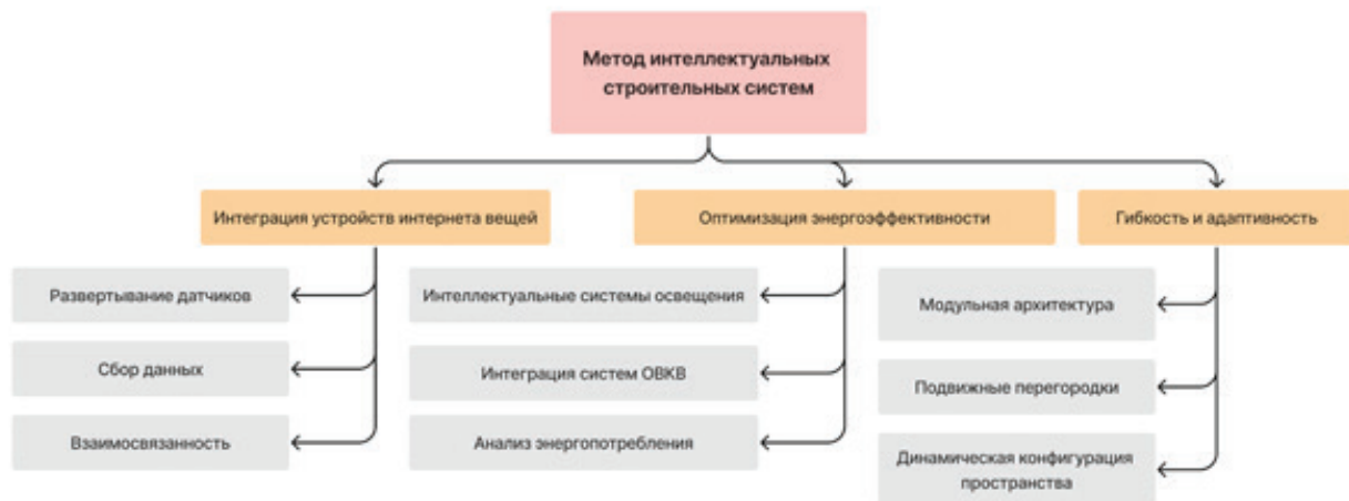
Рис. 3. Главные компоненты метода интеллектуальных строительных систем при архитектурно-экологической реновации промышленных зданий. Схема Н.С. Здора
