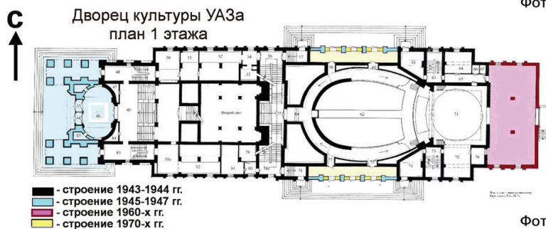
Рис. 9.1. План 1 этажа здания ДК УАЗа. История строительства. Чертёж Т.А. Коротовских.
