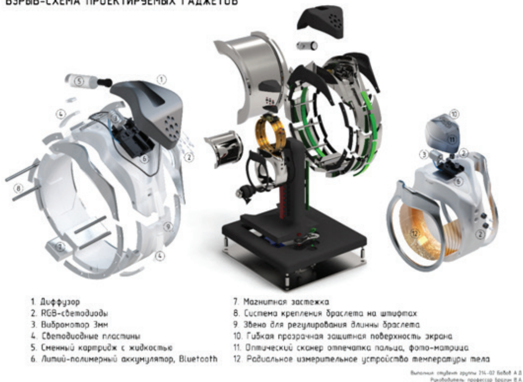
Рис. 7. Взрыв-схема браслета, зарядной станции, кольца
