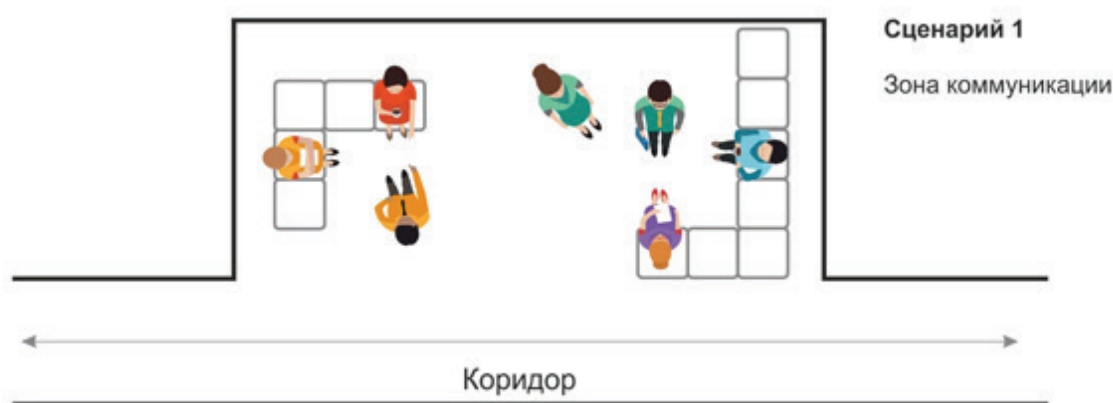
Рис. 2. Схема организации пространства в рекреации при использовании его в качестве зоны коммуникации и социального общения. Сост. А.И. Романова
