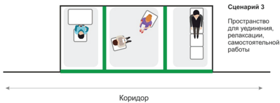
Рис. 4. Схема организации пространства в рекреации с помощью раздвижных перегородок, позволяющих создать отдельные пространства для уединения, релаксации и самостоятельной работы. Сост. А.И. Романова
