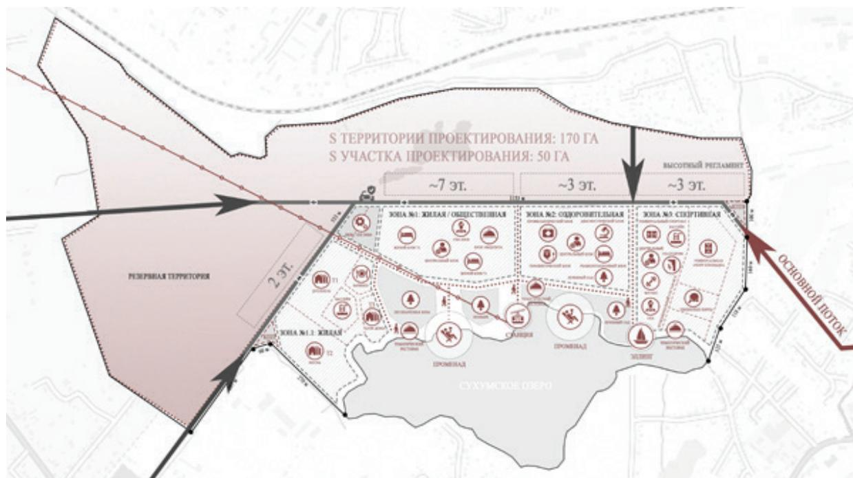
Рис. 9. Схема оптимального варианта организации функционально-планировочной структуры комплекса (на примере территории Сухумского озера в Сухуме)
