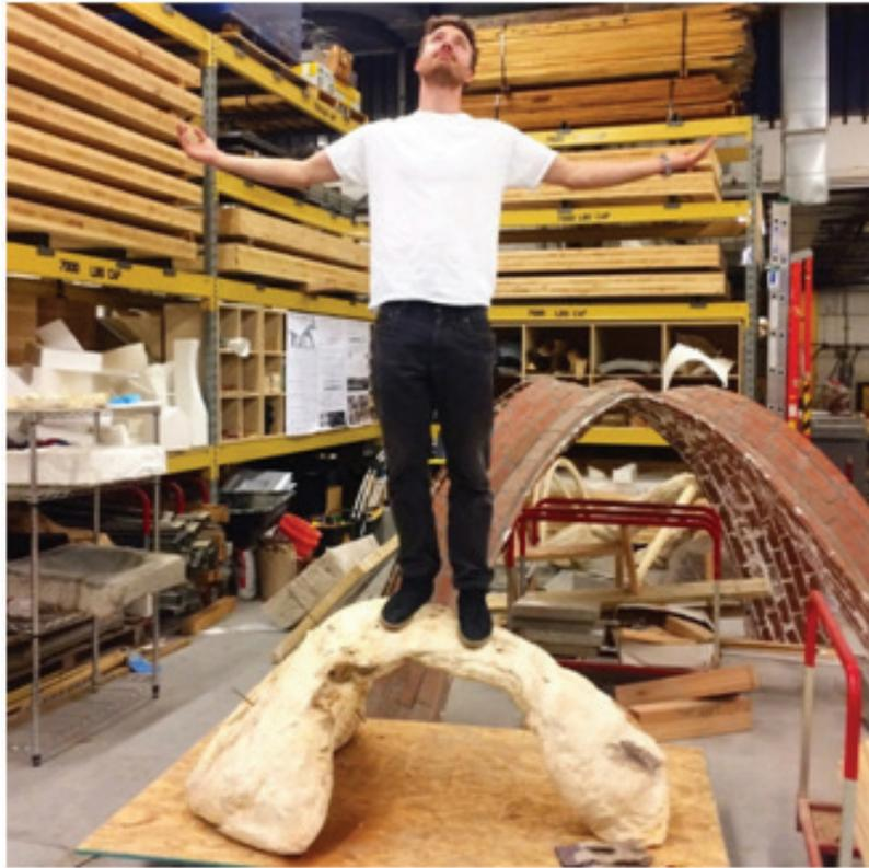
Рис.7. Проверка стабильности конструкции прототипа, 2018. Атланта, США Источник: [https://freight.cargo.site/w/1080/q/94/i/c1b60cfa7ddd0f6e9c0934f59c3efae40a403d6bf6bd7c70826606b8ad1cf08/IMG\\_9023.JPG](https://freight.cargo.site/w/1080/q/94/i/c1b60cfa7ddd0f6e9c0934f59c3efae40a403d6bf6bd7c70826606b8ad1cf08/IMG_9023.JPG)
