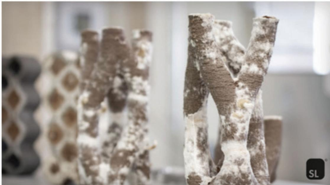
Рис. 10. Объект, напечатанный по технологии 3D-печати «MyCera», фотография исследовательской группы «Shape Lab»
