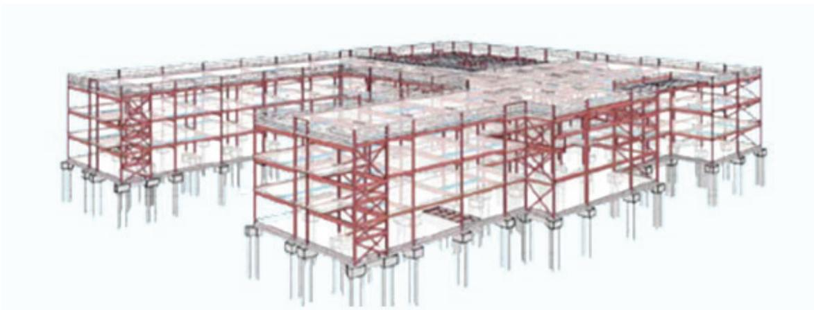
Рис. 6. Пространственная модель каркаса школы в Хартпуле [6]
